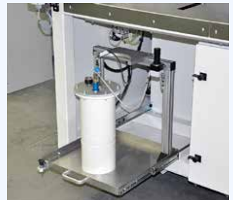
Tankstation 5l anaerob mit Tankauszugwanne
