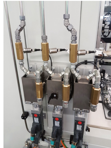
Volumetrische Dosierung (Zahnradpumpen) inkl. Ein- & Ausgangsdrucküberwachung
