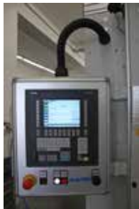
Bedien-Panel mit Klappscharnier
