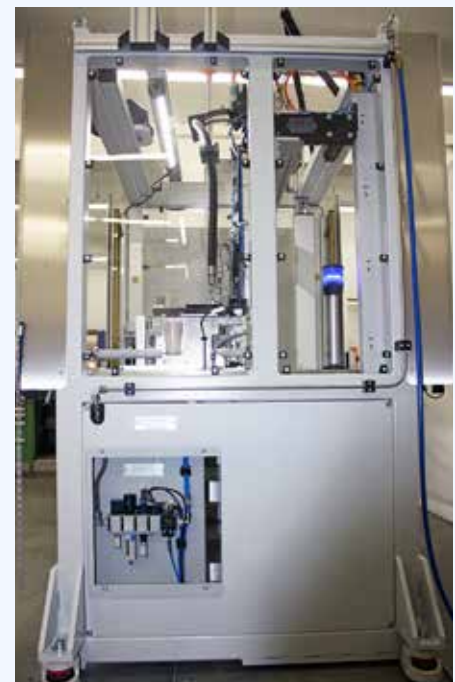
Seitenansicht mit 2 Lichtgittern, LED Maschinenbeleuchtung und Pneumatikeinheit
